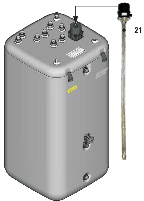
Obrázek 3-7 Poloha montáže elektrické topné tyče (znázorněno na Sanicube Solaris)
